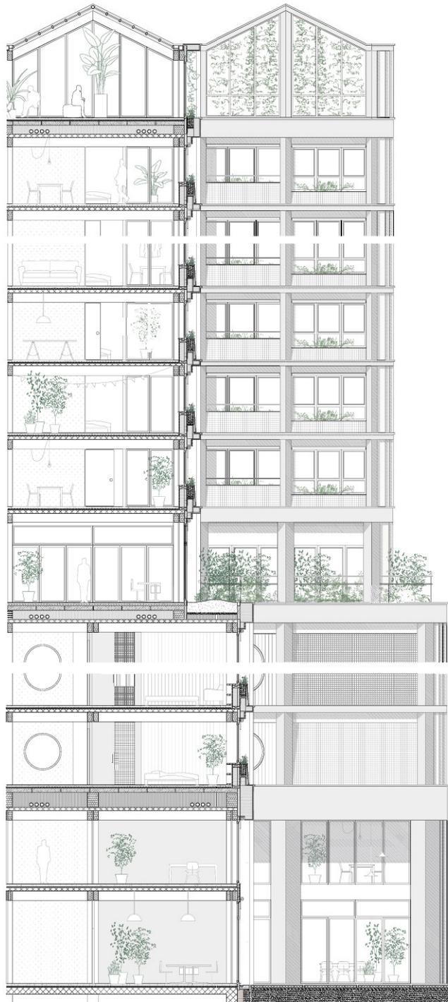
Konstruktionsschnitt und Ausschnitt Fassade 1:200
