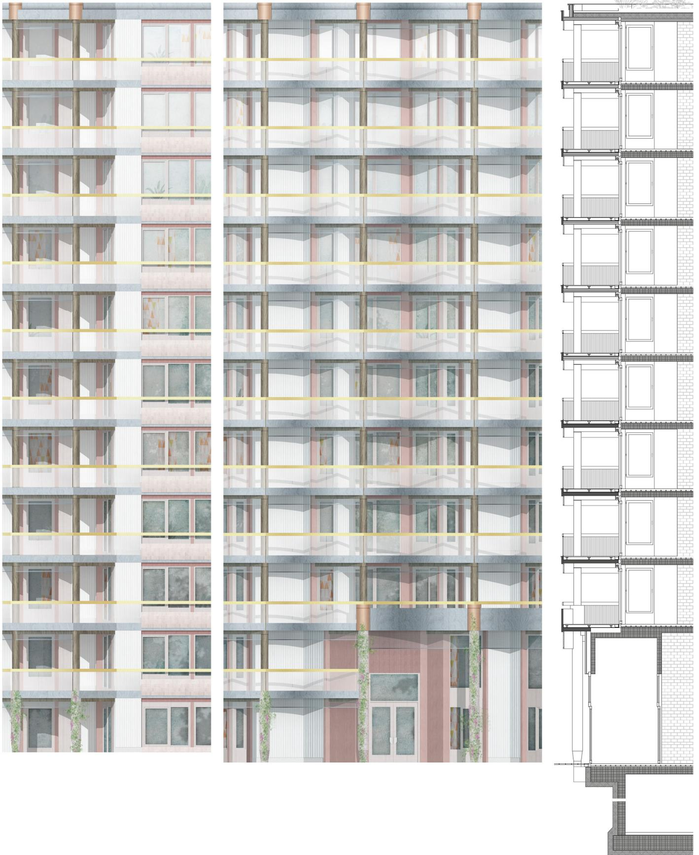
Ausschnitt und Konstruktionsschnitt Fassade 1:150
