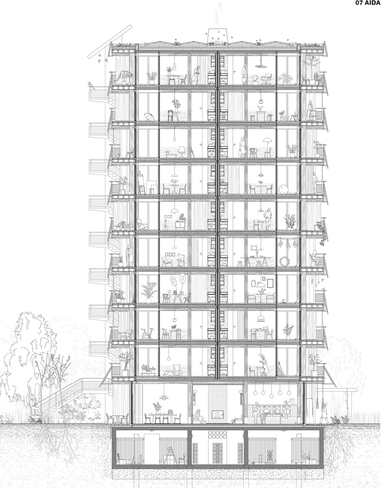
Konstruktionsschnitt Fassade 1:150
