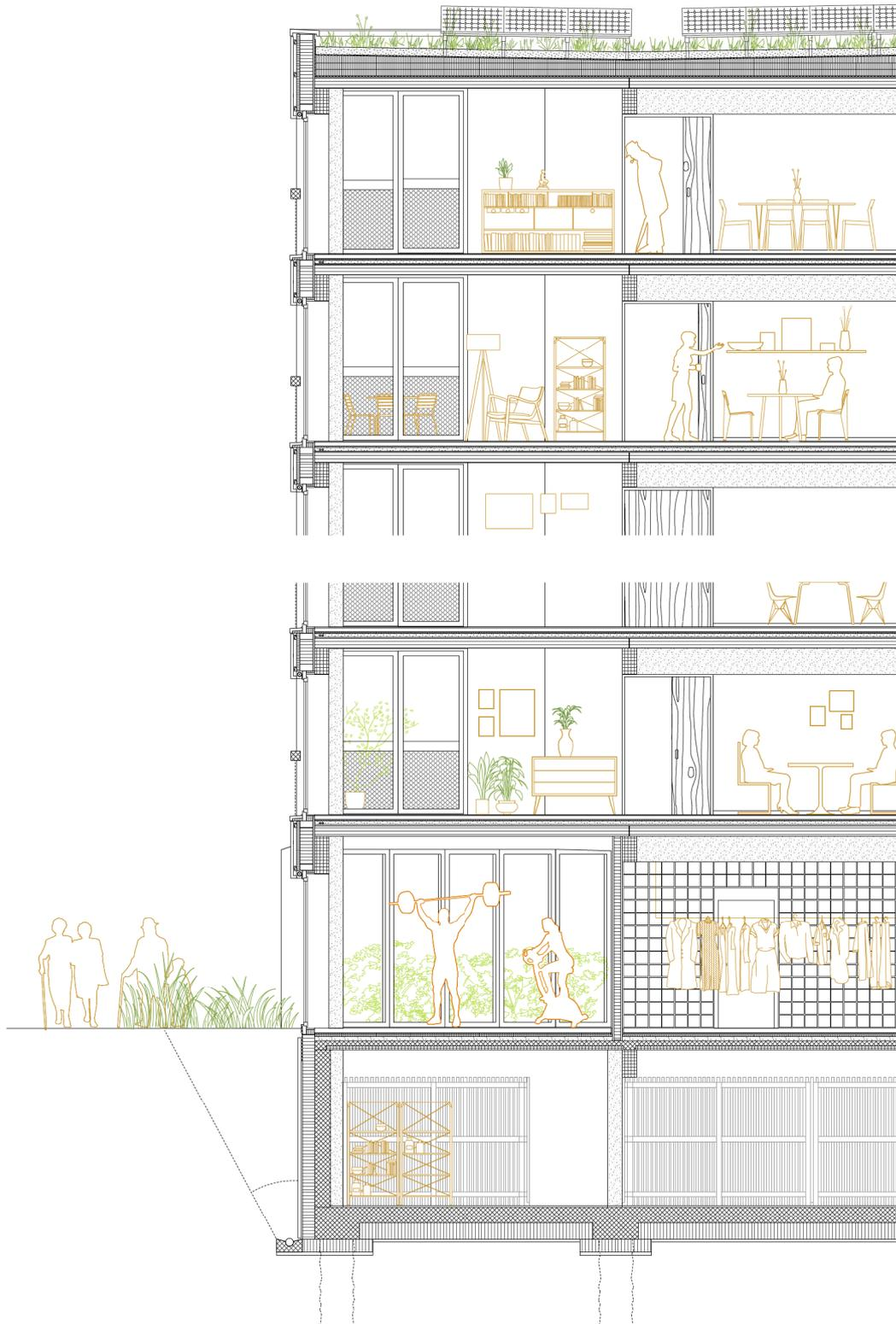
Konstruktionsschnitt Fassade 1:100
