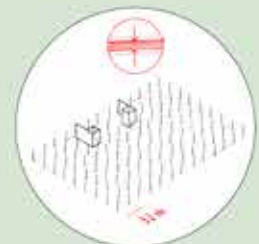
Ökologisches Tragwerk Der Stützenraster ist bewusst eng gewählt. Dadurch können wir den Stahl in den Decken reduzieren und folglich die CO 2 -Bilanz des Projekts deutlich zu verbessern.
