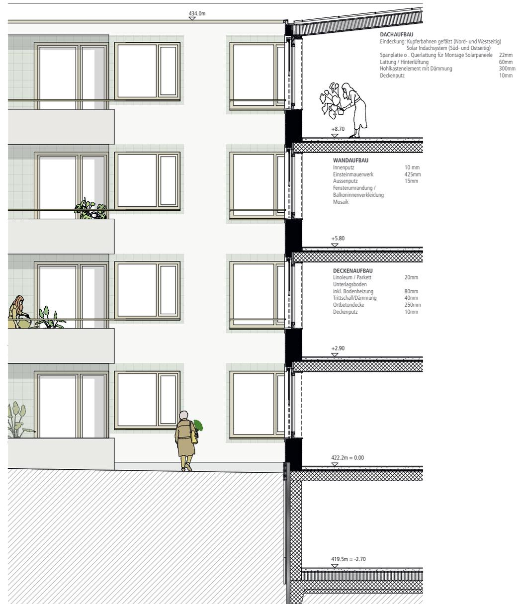
Detailschnitt Fassade 1:100
